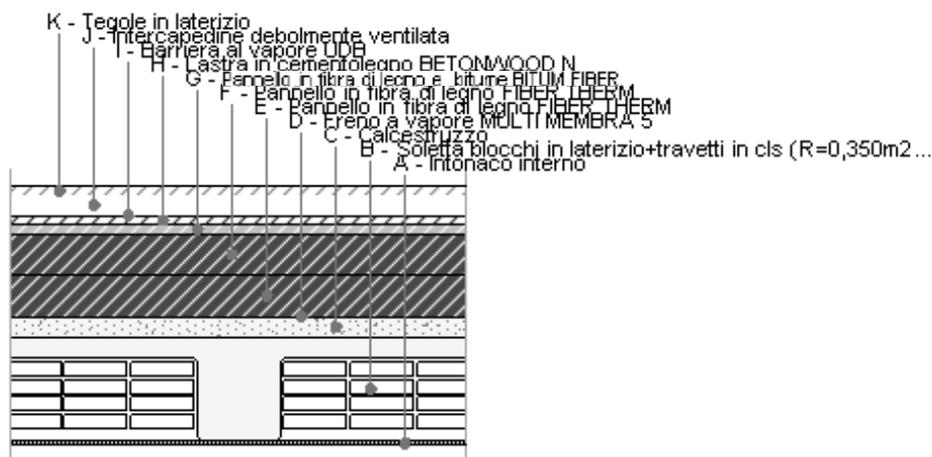
Sfasamenti termici in relazione allo spessore degli strati isolanti in fibra di legno e cementolegno:
