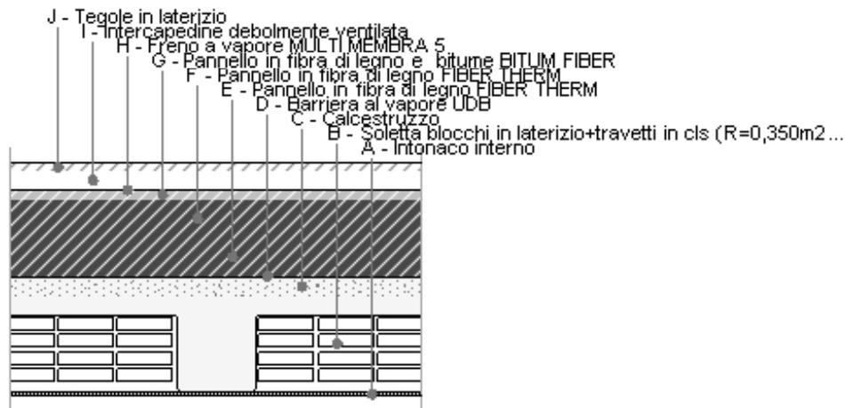
Sfasamenti termici in relazione allo spessore degli strati isolanti in fibra di legno:
