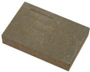
**BetonWood N** Il pannello BetonWood, ad alta densità ( $1350 \text{ Kg/m}^3$ ), realizzato in conglomerato cementizio tipo Portland e fibra di legno di Pino scortecciato. Caratteristiche termodinamiche: coefficiente di conduttività termica  $\lambda=0,26 \text{ W/mK}$ , calore specifico  $c=1,88 \text{ KJ/Kg K}$ , coefficiente di resistenza alla penetrazione del vapore  $\mu=22,6$  e classe di reazione al fuoco A2-fl-s1, secondo la norma EN 13501-1.
